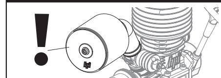
Der Motor darf niemals ohne Luftfilter betrieben werden. Le moteur ne doit jamais tourner sans que le filtre à air soit en place.
