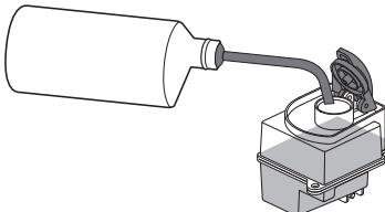
Füllen Sie den Tank komplett mit Kraftstoff. Verwenden Sie nur Kraftstoff mit 20 bis 25% Nitromethan Anteil. Verwenden Sie nur hochwertigen Kraftstoff für Modellautos. Kraftstoff der nicht speziell für Modellautos ist, kann einen Verlust der Garantie bewirken.
