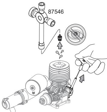
Falls zuviel Kraftstoff im Zylinder ist, kann der Motor nicht starten. Folgen Sie den aufgeführten Schritten, um den überflüssigen Kraftstoff zu entfernen.
