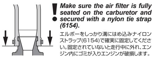
エルボーをしっかりと溝にはめ込みナイロンストラップ(6154)で確実に固定してください。固定されていないと走行中に外れ、エンジン内にゴミが入りエンジンが破損します。
