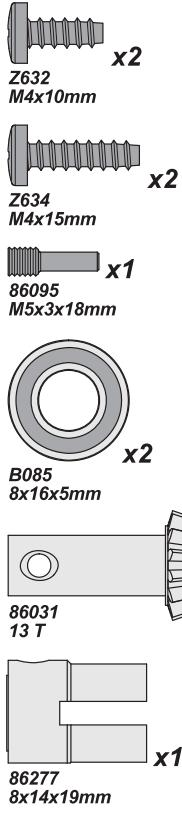
**2** *Differential Case Assembly* *Montage du boîtier de différentiel*
