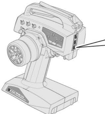
**1 Reverse Switch / Servowegschalter / Commutateur d'inversion / リバーススイッチ**
