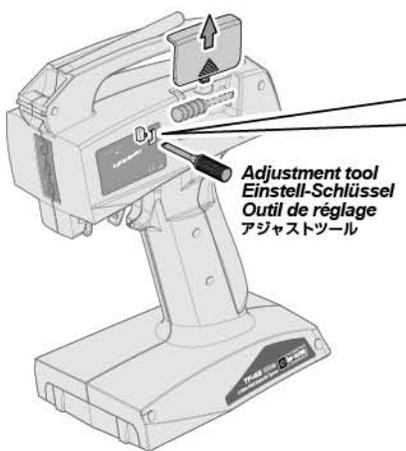
**2 Mode Switch / Modus-Schalter / Commutateur de mode / モードスイッチ**
