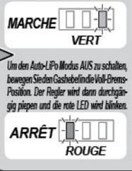
Lassen Sie den Gashebel los, so dass er in die Neutralposition geht. Alle LEDs werden dann blinken und Sie hören eine Tonfolge. Sobald die gelbe LED durchgängig leuchtet, ist Ihr Regler bereit zum Fahren.
