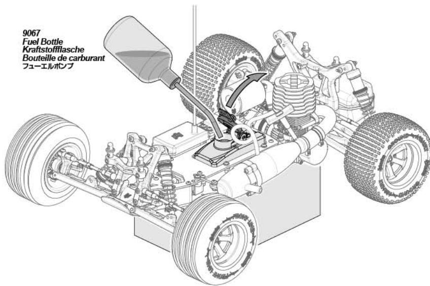
**2** Priming Engine Füllen des Vergasers Amorçage du moteur 燃料をキャブレターに送る
