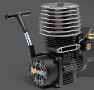
#15107 - NITRO STAR T3.0 MOTOR (MIT SEILZUGSTARTER) 6.5mm Drehvergaser/ABC/ Standard-Welle/Seitenauslass/ Kuehlkopf/schwarzes Kurbelwellengehaeuse
